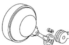
Montar las palancas (H) y el flotador (L) apretando el pasador (I) en el alojamiento apropiado, forzando hasta que salte.
