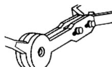
Fügen Sie den Blockierkeil (A) zwischen den beiden Hebeln (H) ein und lassen sie die Bolzen vorläufig in den großen Öffnungen.
