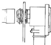
Perforar la pared del depósito con un diámetro de 1-2 mm superior al de la rosca de la válvula.
