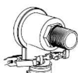
Agganciare le leve (H) sui perni del blocco posti sul retro dello stesso, avendo cura che la cavità superiore s' innesti nel traversino (F).
