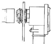
Forare la parete del serbatoio con diametro 1-2 mm superiori a quello della filettatura della valvola.
