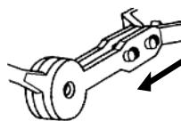
Schieben Sie den Blockierkeil (A) zur Verbindung der Hebel (H) bis zum Anschlag in Richtung Schwimmer (L).
