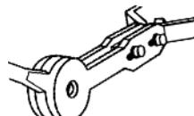
Introduire la clavette de blocage (A) entre les deux leviers (H) en laissant provisoirement les pivots dans les grands emplacements.
