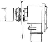
Monter les éléments comme indiqué sur le croquis et serrer la rondelle filetée (D).
