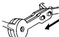
Per unire le leve (H), spingere la chiavetta (A) di bloccaggio verso il galleggiante (L) fino allo scatto.
