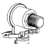
Haken Sie die Hebel (H) in die Bolzen des Riegels, die sich an der Rückseite desselben befinden, ein und beachten Sie dabei, dass der obere Hohlraum in den Steg (F) einrastet.
