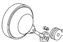
Montieren Sie die Hebel (H) und den Schwimmer (L), indem Sie den Bolzen (I) bis zum Anschlag in die entsprechende Öffnung schieben.
