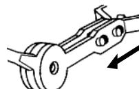
Pour unir les leviers (H), pousser la clavette (A) de blocage vers le flotteur (L) jusqu'à ce que se produise le déclic.
