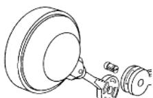
Monter le levier (H) et le flotteur (L) en poussant la cheville (I) dans l'emplacement prévu à cet effet en forçant jusqu'à ce que se produise le déclic.
