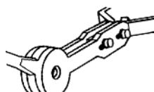
Inserire la chiavetta di bloccaggio (A) fra le due leve (H) lasciando provvisoriamente i perni negli alloggiamenti grandi.
