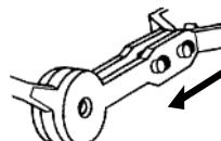
Para unir las palancas (H), empujar la chaveta (A) de bloqueo hacia el flotador (L) hasta que salte.
