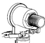
Enganchar las palancas (H) sobre los pernos del bloqueo situados en la parte trasera del mismo, cuidando que la cavidad superior se encastre en la traviesa (F).
